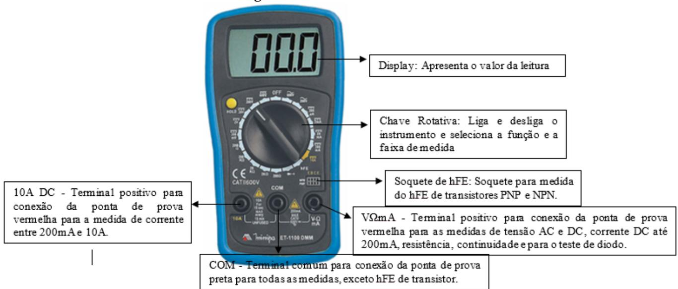
com distorção e outras formas de onda alternadas como quadradas, triangulares, o multímetro deve apresentar leituras True-RMS. Os multímetros True-RMS medem com precisão formas de ondas distorcidas.
