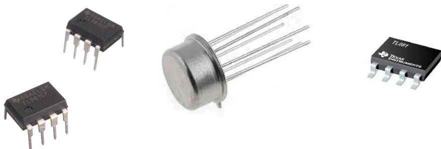
Nestas embalagens os terminais do componente são conectados conforme a figura 8.3. Mas é importante salientar que a posição dos pinos varia de um modelo para outro, conforme o manual do fabricante, neste caso o amplificador operacional é do modelo TL081.
