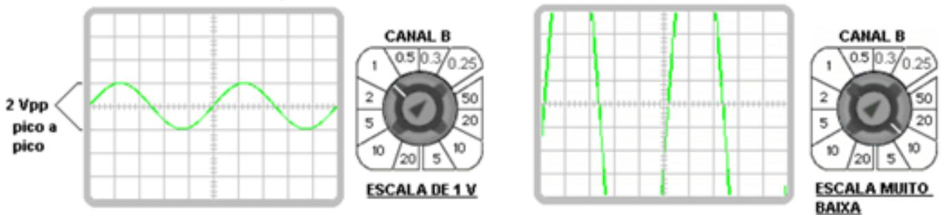
Se não se sabe o valor da tensão do sinal que vai ser medido, comece com a maior escala e use o fator  $\times 10$  da ponta de prova. Após vá abaixando a escala até se conseguir uma leitura precisa do valor. Deve-se certificar também a tensão máxima que as ponteiros e osciloscópio suportam.
