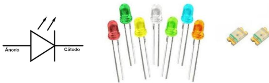
de chaveamento são indicados na condução de altas correntes em circuitos chaveados. Dependendo das características dos materiais e dopagem dos semicondutores há uma gama de dispositivos eletrônicos variantes do diodo. A figura 6.6 mostra algumas destas variações.
